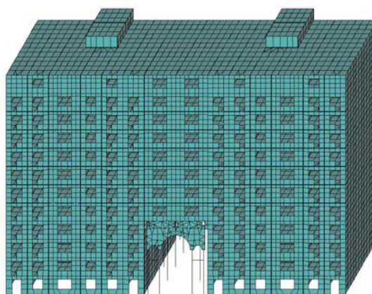
Рис. 2. КЭ-модель панельного здания с арочным проездом
